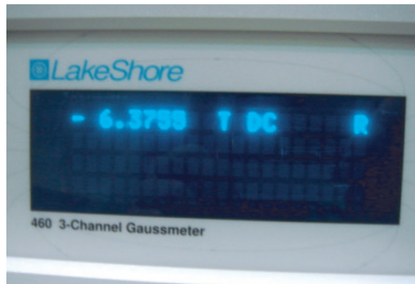
ภาพแสดงค่าสนามแม่เหล็กสูงสุด (Peak Field) ของ Superconducting WLS วัดได้ตามค่าที่ออกแบบไว้
