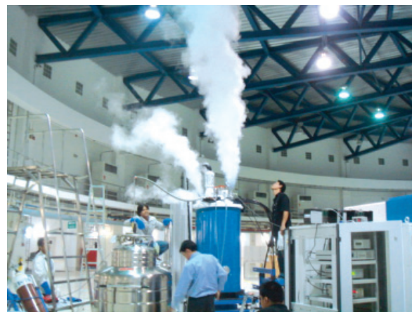
ภาพแสดงการเกิด Quenching ของแม่เหล็กขณะทำการจ่ายกระแส
