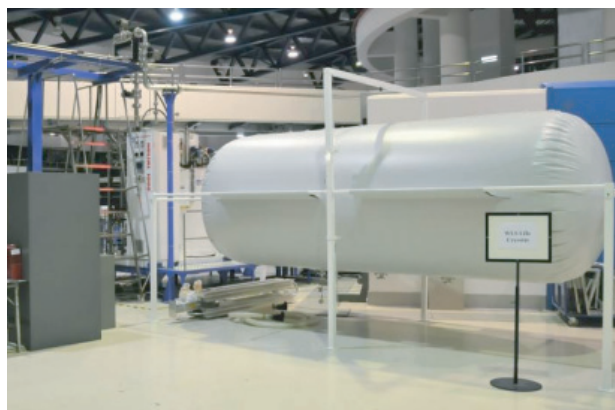
ภาพแสดง Cold Box และระบบจัดเก็บแก๊สฮีเลียมภายในอาคารห้องปฏิบัติการแสงสยาม
