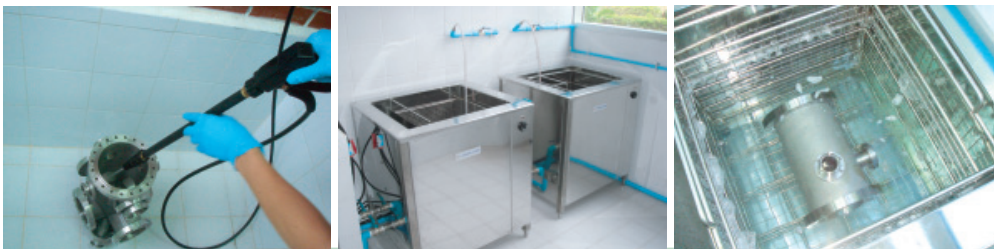
ภาพแสดงปั่นฉีดน้ำแรงดันสูงและถังล้าง Ultrasonic ในห้องล้างอุปกรณ์สุญญากาศของสถาบัน
