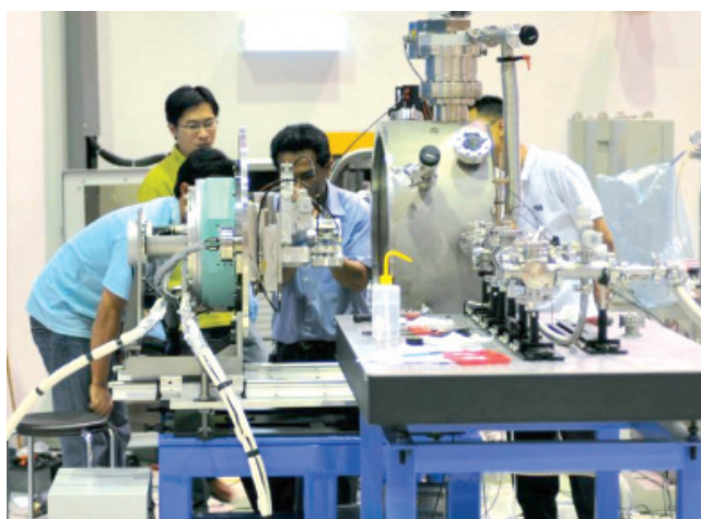
ภาพแสดงโมโนโครเมเตอร์ที่สร้างขึ้นที่สถาบันสำหรับเทคนิค Protein Crystallography ซึ่งกำลังอยู่ระหว่างการทดสอบการทำงาน
