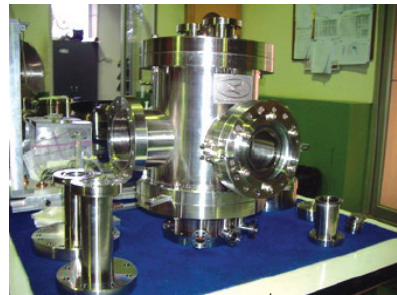
Sputtering Chamber ที่สถาบันสร้างสำหรับกลุ่มวิจัยมหาวิทยาลัยขอนแก่น
