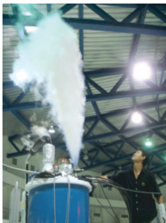
ภาพแสดงการเกิด Quenching ของแม่เหล็กขณะทำการจ่ายกระแส
