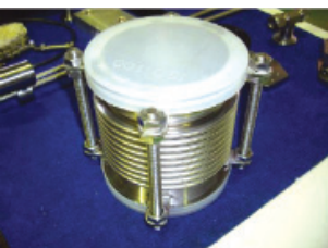
Bellow, ดัดแปลงสำหรับการติดตั้ง Array Detector ของ Beamline
