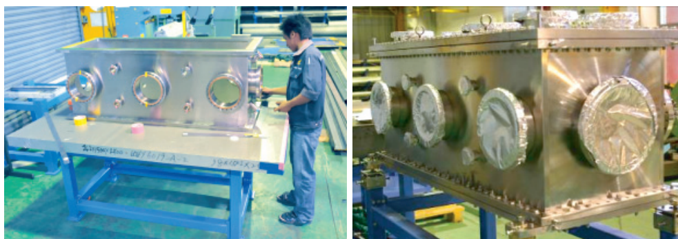
ภาพแสดงห้องสุญญากาศของระบบทำแสงขนาน สำหรับเทคนิค Protein Crystallography
