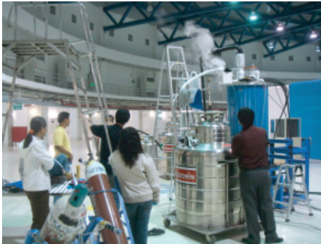
ภาพแสดงการหล่อเย็นของแม่เหล็ก Superconducting WLS จนถึงอุณหภูมิ -269 C
