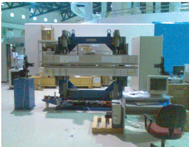
Undulator U60 และระบบวัด Field Integral ขณะกำลังดำเนินการวัด
