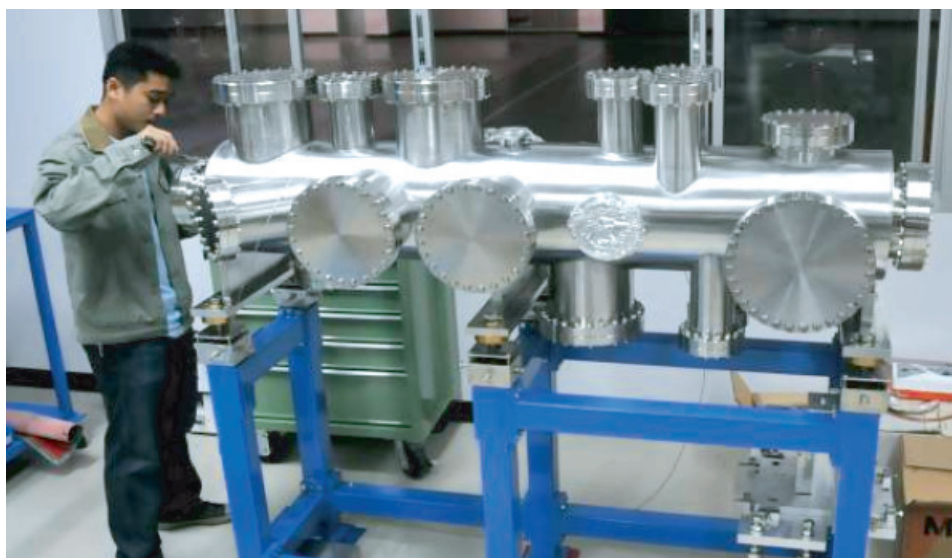
ภาพแสดงห้องสุญญากาศของส่วนหน้าระบบลำเลียงแสงสำหรับเทคนิค Protein Crystallography
